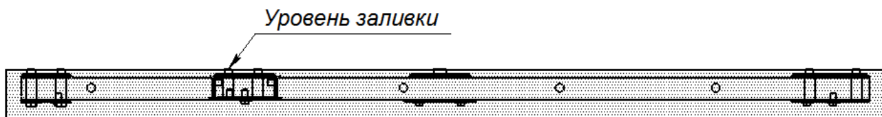
Рисунок 3. Схема установки и заливки рамы
